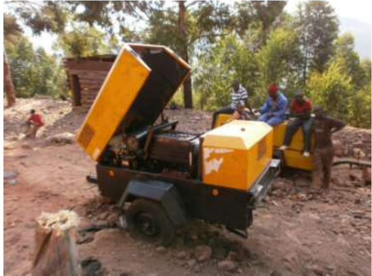
Photo 5: Dispositifs d'éclairage et d'oxygénation le long des tunnels sur un site minier de la Commune de Butihinda, Province de Muinga.
